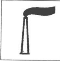
提示图形符号：一个矩形框内，上方是一个废气排放口的烟囱，下方是飘出的废气，表示废气排放。      |
