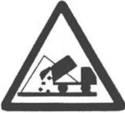
警告图形符号：一个三角形框内，上方是一个垃圾车正在倾倒垃圾，下方是堆积的垃圾，表示一般固体废物。 | 表示一般固体废物贮存、处置场 |
