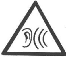
警告图形符号：一个三角形框内，左侧是一个耳朵，右侧是三个向外扩散的半圆，表示噪声排放。       | 表示噪声向外环境排放     |
