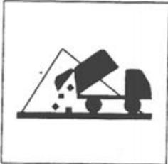
提示图形符号：一个矩形框内，上方是一个垃圾车正在倾倒垃圾，下方是堆积的垃圾，表示一般固体废物。 |
