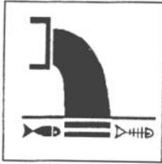
提示图形符号：一个矩形框内，上方是一个污水排放口的管道，下方是两条鱼，表示污水排放。        |
