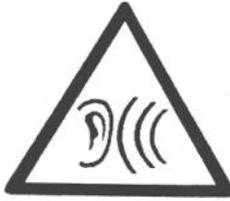
警告图形符号：一个三角形框内，左侧是一个人的耳朵，右侧是三个向右扩散的半圆弧形，表示声音的传播。           | 表示噪声向外环境排放     |
